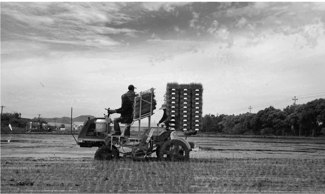
今年春耕备耕中，浙江省温岭市的早稻生产继续推进轻简化移栽技术，重点推广钵苗有序抛秧和摆栽，有效保障粮食生产面积稳中有升。这是温岭市东浦新塘宏旺农业机械化专业合作社，正用新型钵苗插秧机移栽早稻秧苗。
